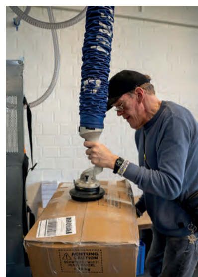
Michael Peeters, beschäftigter Mitarbeiter in der Verpackungsgruppe, hebt eines der schweren Pakete mit dem Vakuumheber vorsichtig an.
